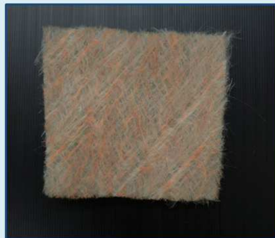
Filtro in fibra di vetro tipo: Dust
